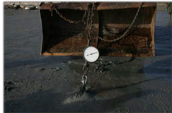
Essais d'arrachement d'ancre à vis Ø25mm, longueur 1m, 1 hélice
